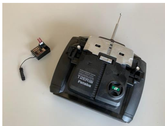
市售 3 通道 27MHz 板型遙控收發器
